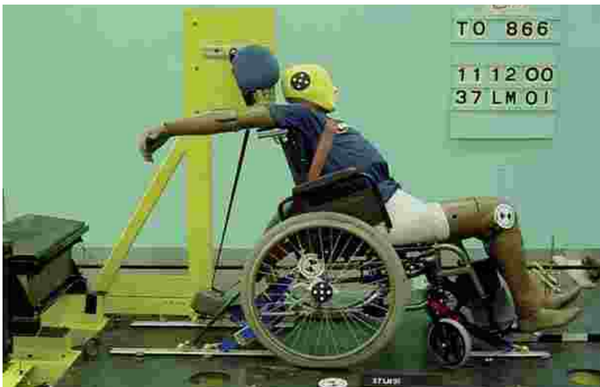
Silla de ruedas sujeta a los raíles, después del impacto
